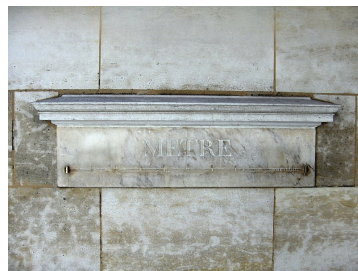
Slika 8.12 Meter – palica za merjenje dolžine. Prikazan je javni etalon, izdelan na podlagi meritev poldnevniškega loka skozi Francijo. Etalon je vzidan v pročelje hiše v Parizu. (Anon)
