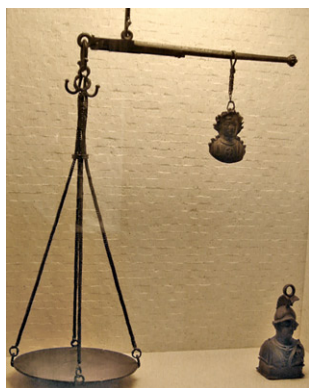
Slika 9.6 Raznokraka tehtnica. Razmerje dveh sil (tež) je obratno sorazmerno z razmerjem njunih ročic. Za tehtanje je zato dovolj ena sama premična utež. In tehtati je možno zelo velika bremena. Prikazana je tehtnica iz rimske dobe. (Musee du Louvre, Pariz)
