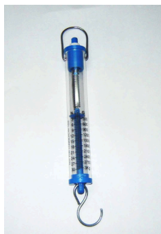
Slika 9.2 Vzmetna tehtnica – merilnik teže in drugih sil. Daljši ko je raztezek vzmeti, večja je sila. Tehtnico umerimo z znanimi utežmi. Prikazana je prozorna tehtnica za demonstracijske poskuse. (Anon)
