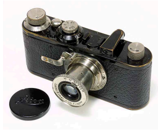
Slika 27.15 Fotografska kamera – naprava za slikanje predmetov. Prikazana je ena od prvih kamer, ki je uvedla pomični fotografski trak. Opremljena je s kukalom in obročki za nastavitve zaslonke, časa in oddaljenosti. (Anon)
