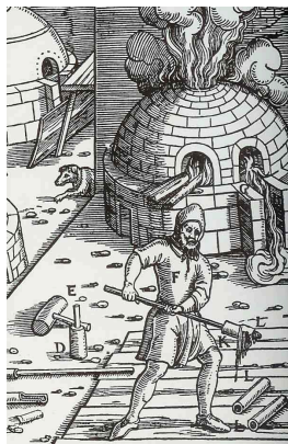
Slika 4.2 Pridobivanje kovin iz rud z ognjem. V peči iz opeke je ruda, pomešana z ogljem. Staljena kovina izteka skozi spodnja vrata. (Agricola, 1556)
